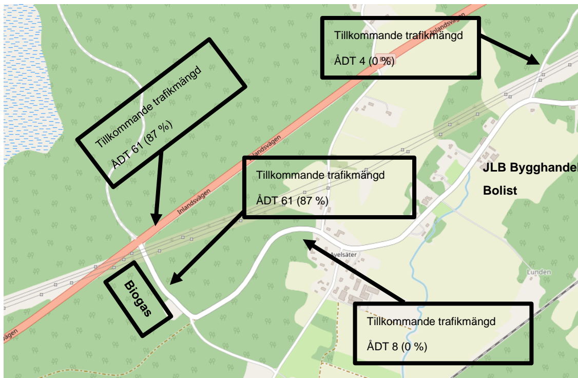
Figur 5. Tillkommande trafikalstring runt om biogasanläggningen. % avser andel tung trafik. Bakgrundskarta © openstreetmaps bidragsgivare.
