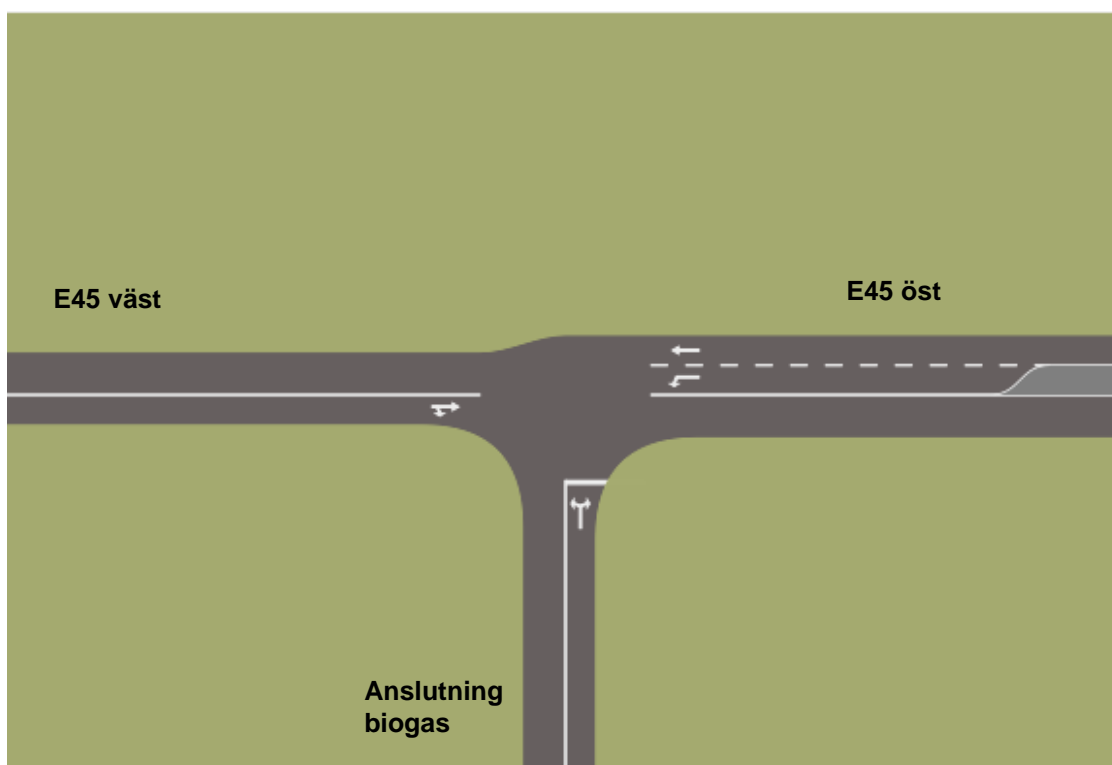
Figur 7. Principutformning av korsning med E45:an i framkomlighetsanalysen. (bild från Capcal).
