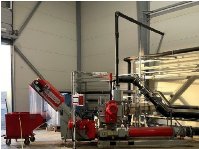
Figur 6 Möjlig teknik för förbehandlingsanläggning inklusive skrotfälla för sten och andra föroreningar. Källa Envitec
