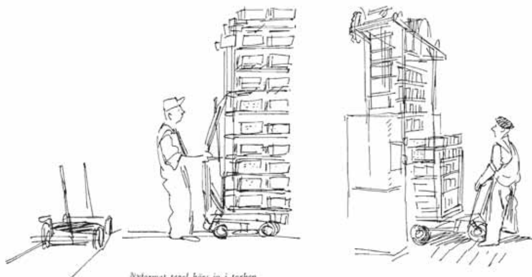
Nyformat tegel körs in i torken T. h. Torkat tegel lastas om till en karusellvagn
